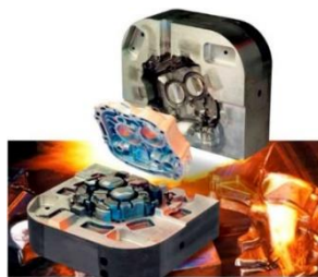
Figure 57: Procédé de moulage en coquille par gravité.
