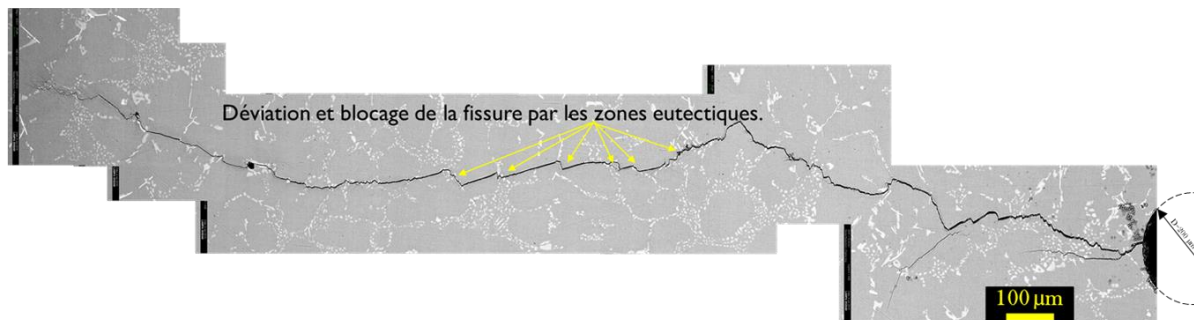
Figure A1. 249: Effet de la microstructure sur la propagation des fissures courtes dans les alliages d'aluminium de fonderie.
