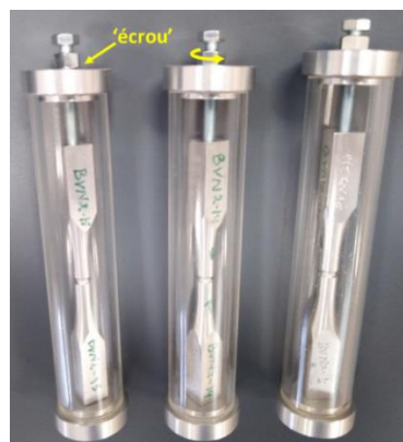
Figure 73: trois éprouvettes entaillées BVN2-14, BVN2-15 et BVN2-16 scannées post-mortem .
