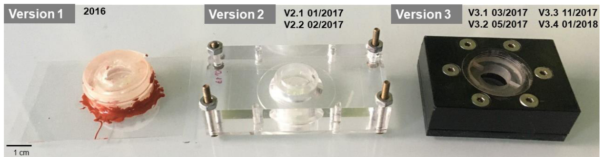
Figure 23 : Premières versions du système de confinement. Version 1 : Système combinant deux joints en PDMS et une fermeture par un bouchon de tube Falcon. Version 2 : Le serrage est assuré par deux pièces en Voltaef. Version 3 : Système principalement conçu par impression 3D, une rondelle de serrage est ajoutée pour plaquer plus spécifiquement le gel.
