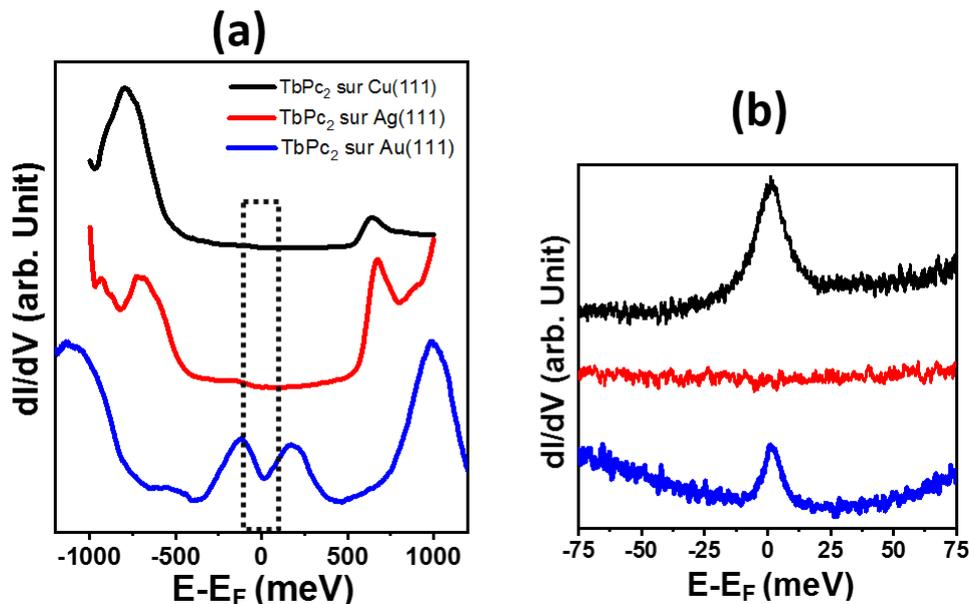
**Figure 2 :** (a) Spectres  $dI/dV$  enregistrées sur le ligand de TbPc<sub>2</sub> déposée sur Cu(111) (noir), sur Ag(111) (rouge) et sur Au(111) (bleu). (b) rectangle marqué sur (a) spectres  $dI/dV$  montrant deux résonances Kondo (noir et bleu) sur le ligand de la molécule TbPc<sub>2</sub> déposée sur Cu(111) et Au(111), Pas de Kondo (rouge) sur le ligand de la molécule déposée sur Ag(111).
