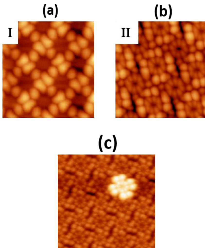
**Figure 1** : Images STM topographiques de domaines d'adsorption de TbPc<sub>2</sub> sur Au(111) avec (a) Phase I et (b)Phase II et sur Ag(111) première et deuxième MC (c).
