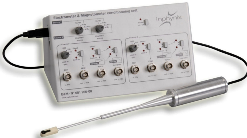
FIGURE 1.4.1 – Photo du condensateur de capture (en noir) couplée à un électromètre. [Robbes 09]
