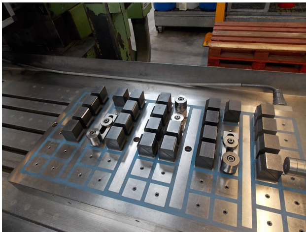
FIGURE 6.7 – Montage - plateau magnétique
