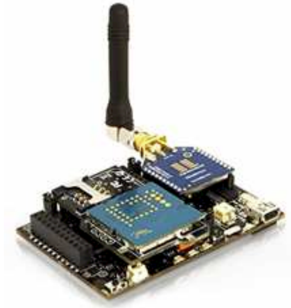
FIGURE 1 – Exemple d'un capteur sans fil (source : (LibeliumWorld 2009)).
