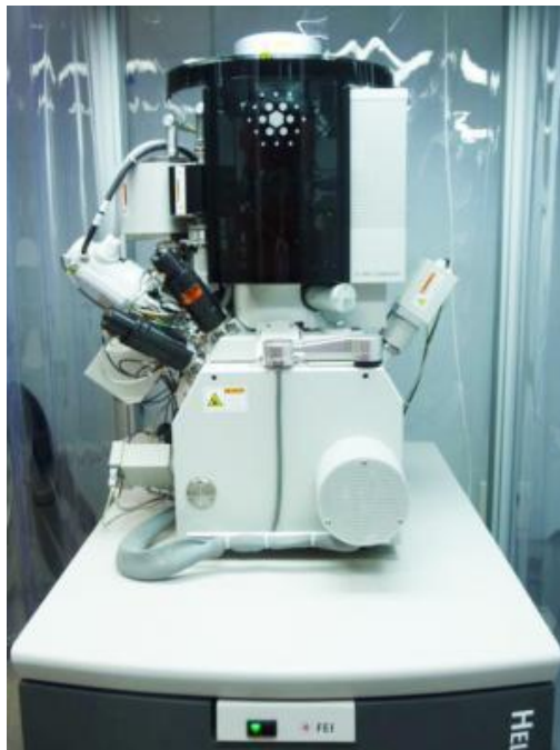
Figure IV.22 Photographie de l'appareil Dual Beam SEM / FIB FEI Helios 600i utilisé pour l'usinage de micro-piliers.
