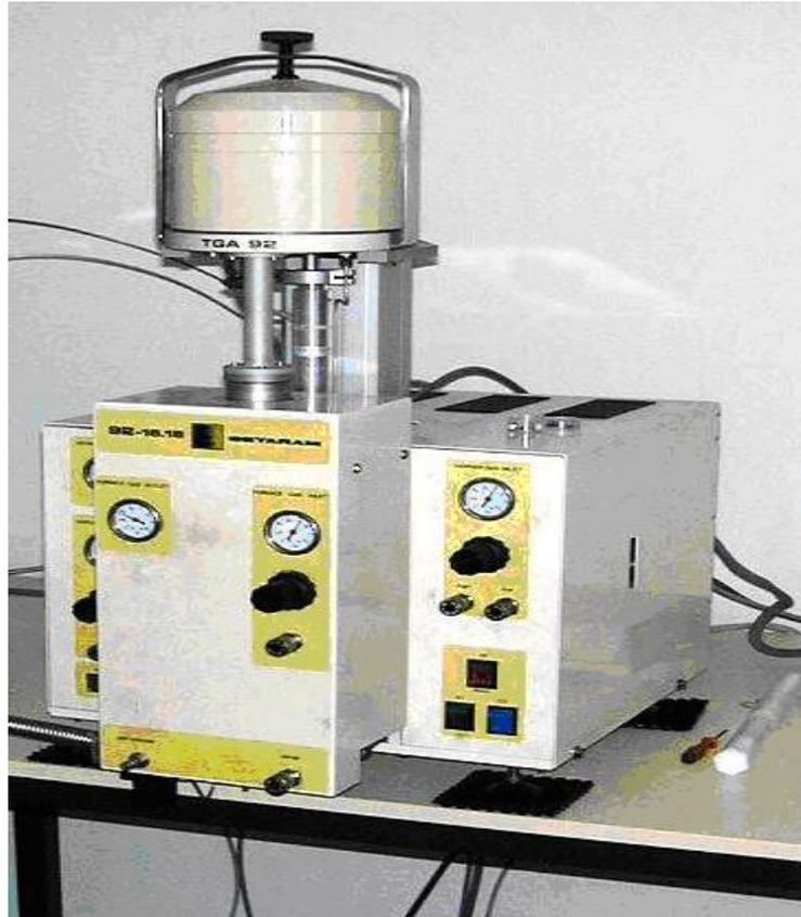
Figure II-26 Thermobalance SETARAM TGDTA 92B du laboratoire LASIE (22)
