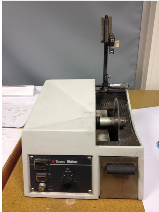
FIGURE 2.11 – Scie utilisée pour le découpage des éprouvettes
