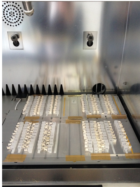
FIGURE 3.2 – Éprouvettes positionnées dans l'enceinte de vieillissement
