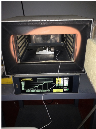
FIGURE 2.32 – Mesure de la température au sein du four
