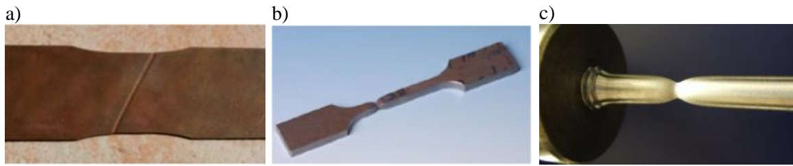
FIG. 1-4 Différents modes de striction ; a) 1 striction d'une plaque type « bande oblique », b) 2 striction d'une plaque type « fossette », c) 3 striction d'un barreau
