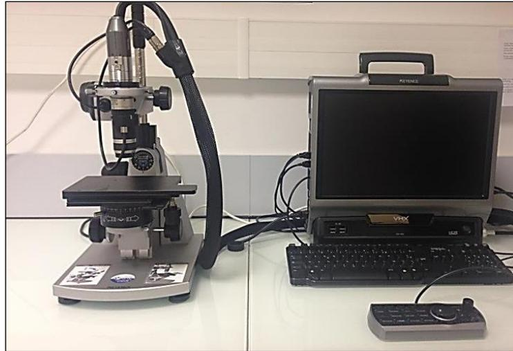
Figure II.10 : Microscope numérique VHX-1000
