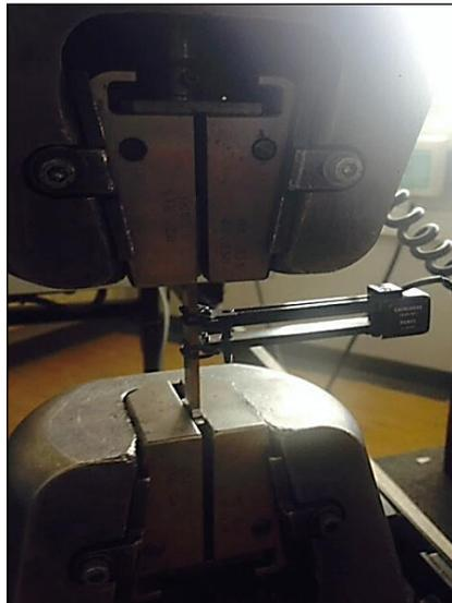
Figure II.1 : Montage d'une éprouvette d'essai sur la machine de traction
