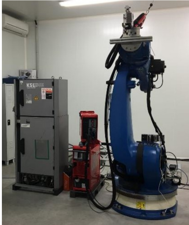
FIGURE 1.3 – Vue de la cellule robotisée de fabrication WAAM présente sur la plateforme Addimadour.
