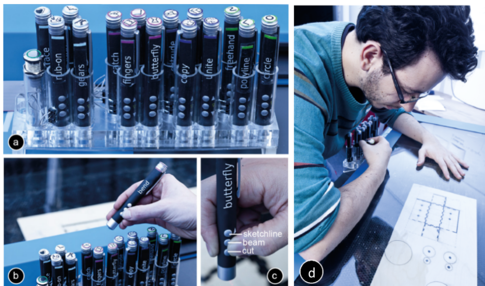
FIGURE 2.7 – Composition 3D Printing : (a,b) 25 stylos pointe-laser spécialisés, (c) Fonctions d'esquisse, de fabrication et de pointage, (d) Aperçu de l'environnement de conception et de fabrication. (Extrait de [156]).
