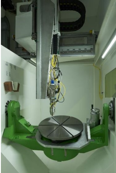
FIGURE 1.1 – Cellule de fabrication de la machine BeAM permettant la fabrication de pièces métalliques par projection de poudre.
