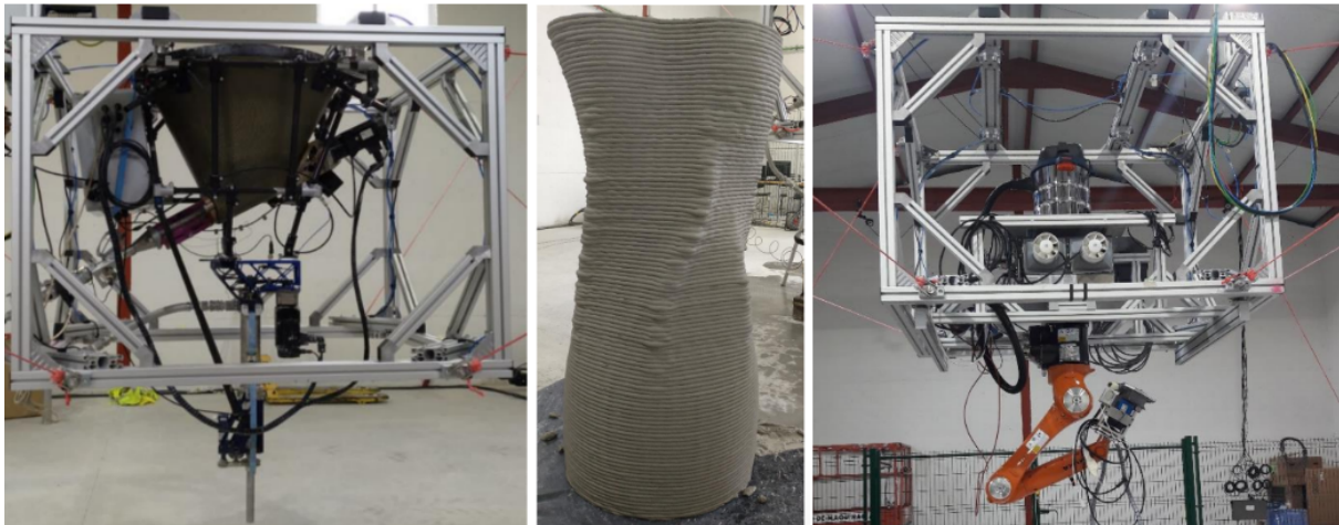
FIGURE 1.5 – Aperçu de la cellule de fabrication HINDCON avec à droite l'outil d'extrusion de béton, au milieu un exemple de pièce fabriquée et à gauche l'outil d'usinage.
