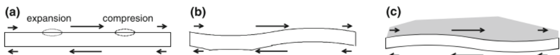
Figura II.9- Deformación flexural en un resonador de cristal de cuarzo. a) formación de un gradiente de amplitud en el movimiento transversal. b) El material se deforma para evitar la compresión. c) Si el cristal se encuentra inmerso en un líquido, este puede ejercer una presión normal a la superficie del resonador causando que se doble hacia el lado contrario. Tomada y adaptada de Johannsmann 2015.
