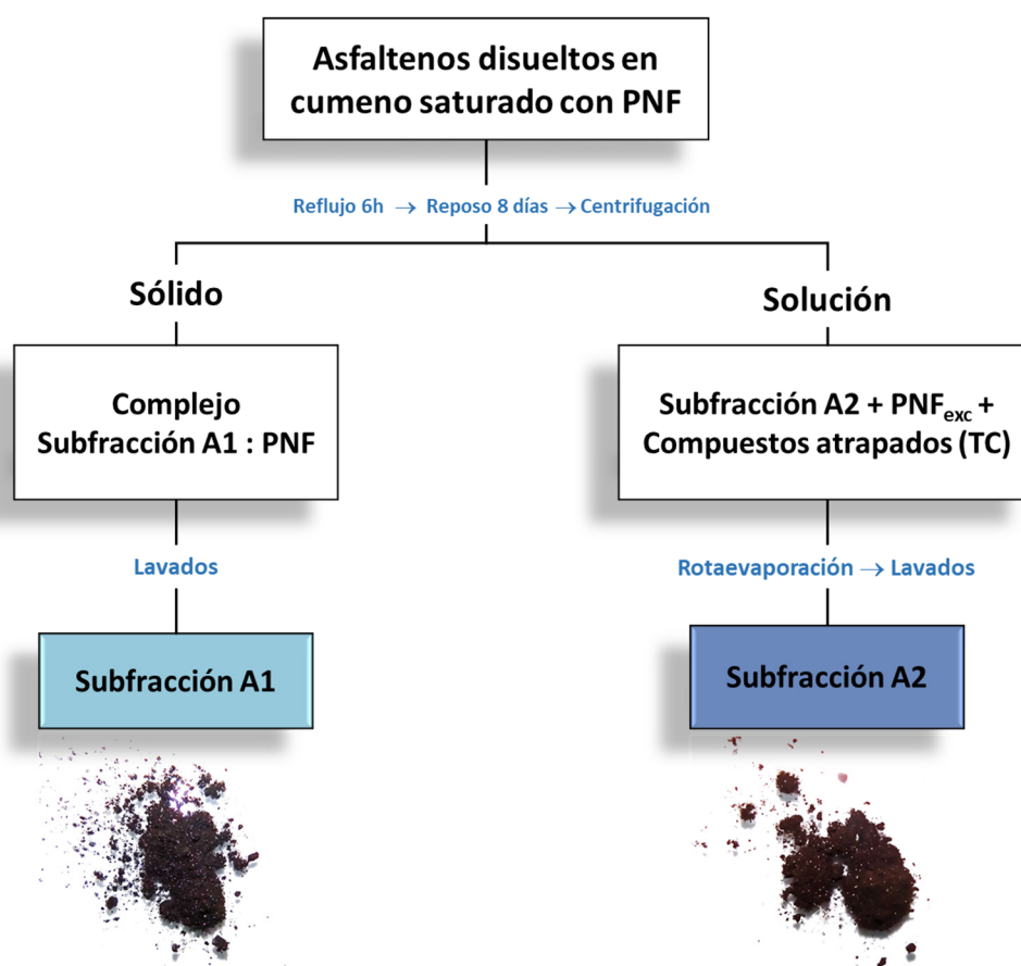
Figura III.2- Esquema simplificado del fraccionamiento por formación de complejo con PNF.
