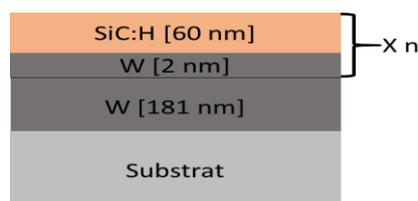
Figure 59 : Représentation schématique de l'architecture des multibicouches W/SiC:H simulées et élaborées.
