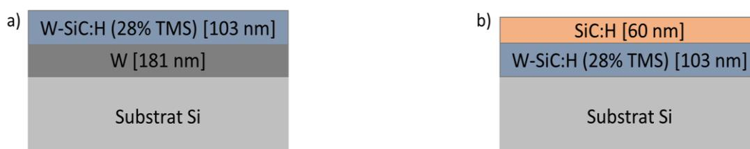
Figure 134 : Design des empilements W/W-SiC:H (a) et W-SiC:H/SiC:H (b).
