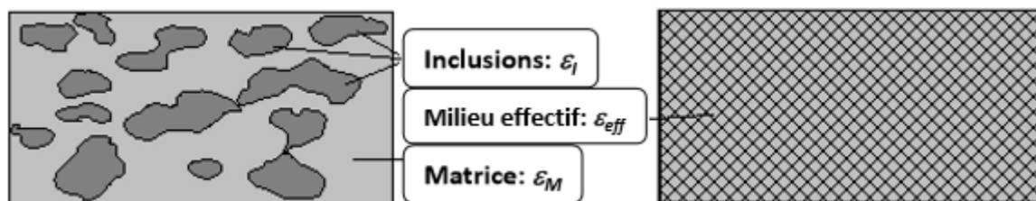
Figure 51 : Schéma représentatif d'un composite constitué de deux phases (inclusions + matrice).
