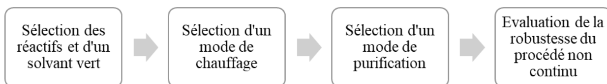
Figure 24 : Etapes de l'optimisation de la synthèse verte en système non continu des nanoparticules de bismuth métallique.
