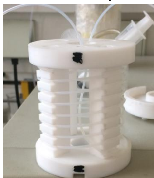
Figure 47: Dispositif de flux continu et caractéristiques de la tubulure insérée dans la cavité microonde.
