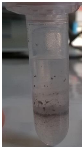
Figure 129: Photo du test de déstabilisation accélérée lors de l'étape 3 de la formulation d'une émulsion perfluorée incorporant des nanoparticules.
