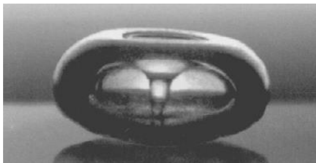
Figure 15 : Implosion d'une bulle de cavitation avec un diamètre de l'ordre de 1 mm à 10 Hz à proximité d'une surface rigide, photographie réalisée par L. Crum [32]
