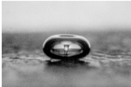
FIGURE I.20 – Photographie de l'implosion d'une bulle de cavitation et du micro-jet de fluide se formant en son centre [25].
