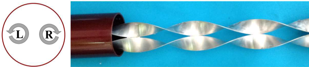
FIGURE I.11 – Photographie d'un tube intégrant 2 rubans torsadés [13].
