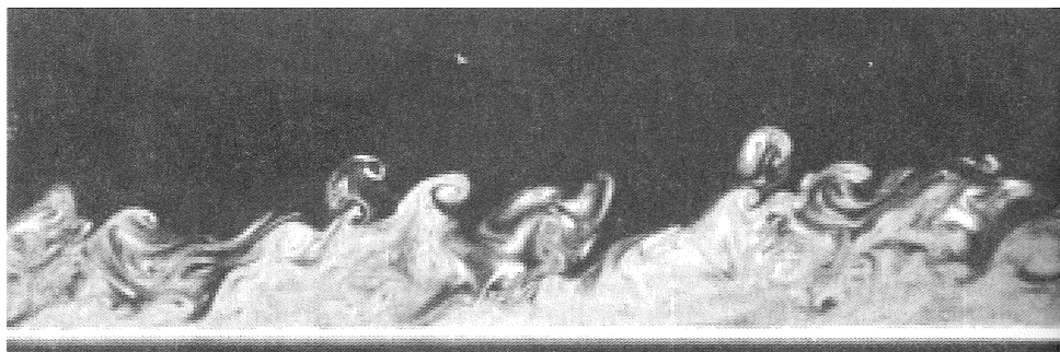
FIGURE I.3 – Visualisation d'une coupe longitudinale de la couche limite turbulente qui se développe sur une plaque plane, dans l'air. D'après les travaux de Laadhari, extrait de Turbulence , par Bailly et al. [5].
