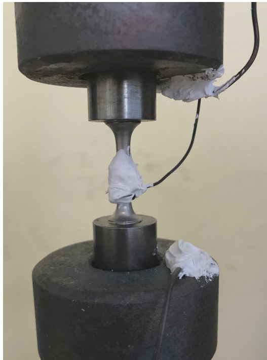
Figure III.18 – Fixation des thermocouples : sur la zone utile de l'éprouvette et dans l'environnement immédiat de l'éprouvette
