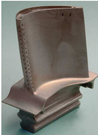
Figure IV.1 – Aube de turbine haute pression du moteur M88 - Safran Aircraft Engines
