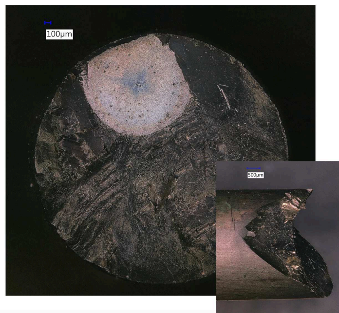
Figure IV.23 – Observation du faciès d'une éprouvette d'AM1 après un essai d'auto-échauffement ( \Sigma_0 = 0,533 , R = 0 et T = 950^\circ\text{C} ) - Éprouvette 3
