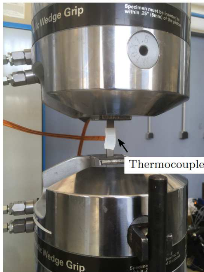
Figure II.5 – Montage expérimental pour un essai d'auto-échauffement à température ambiante sur une éprouvette plate en acier - Machine d'essai de traction-compression et thermocouples de type T [Louge, 2019]
