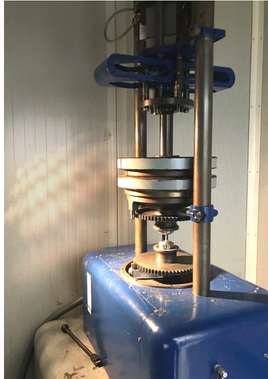
Figure IV.24 – Dispositif expérimental à température ambiante - Vibrophore Zwick Roell
