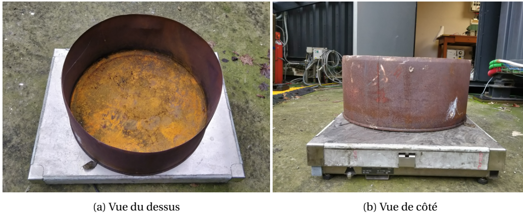
FIGURE 4.1 – Photographies du fût et de la balance de pesé du scénario « hydrocarbure confiné »
