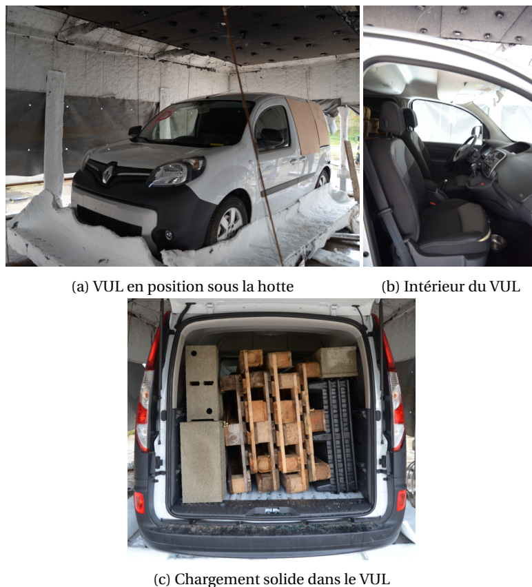
FIGURE 4.15 – Photographies du foyer de VUL et de son chargement.
