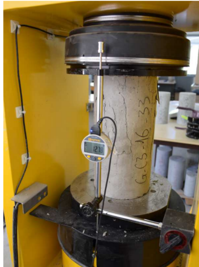
Figure 2.7 – Montage des essais de compression dans les travaux de Vu et al. [2017]. Un capteur LVDT est fixé sur les supports de l'éprouvette.
