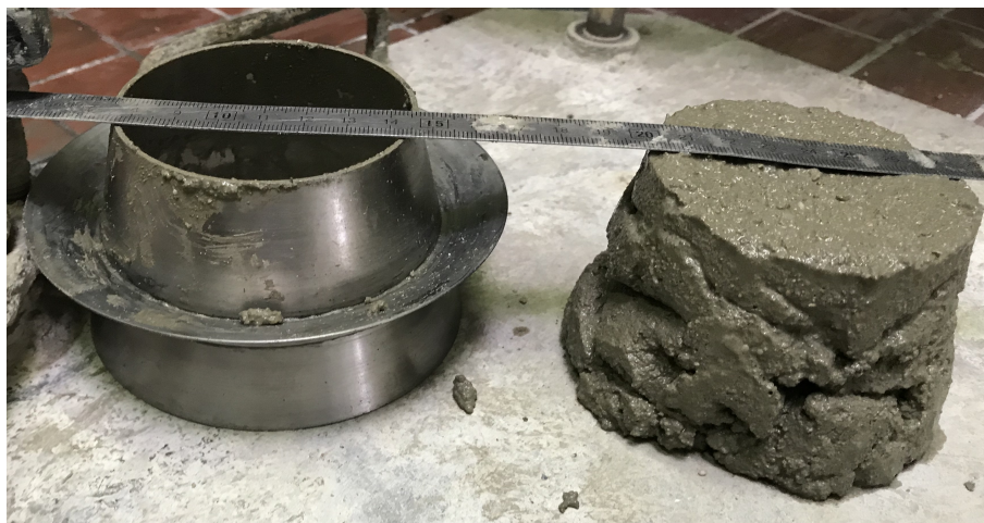
Figure 2.26 – Mini-cône d'Abrams. Pour une hauteur de 10cm, pas d'affaissement significatif est observé, indiquant que le matériau semble ferme.
