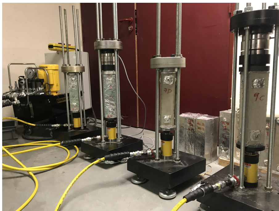
Figure 2.66 – Deux essais de fluage propre (côté gauche) et deux essais de fluage de dessiccation (côté droit).
