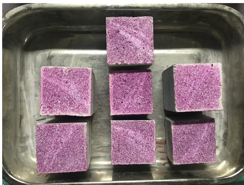
Figure 2.65 – Échantillons carbonatés à J+1 après application de la phénolnaphtaléine pour les échantillons provenant des trois campagnes expérimentales. Chaque spécimen correspond à une observation qualitative d'une éprouvette caractéristique de la gâchée.
