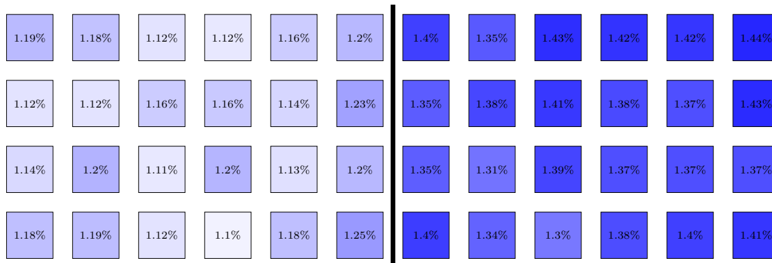
Figure 2.38 – Cartographie C3 : La conservation des éprouvettes dans deux bacs en solution aqueuse ont engendrée la lixiviation des alcalins et une baisse du pH dans le bac à droite.
