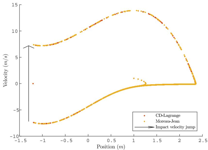
Figure 2.7: Van der Pol oscillator – Phase space
