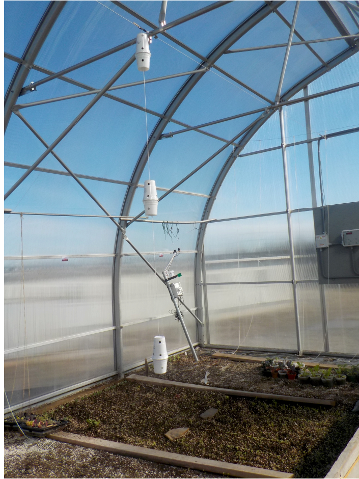
FIGURE 3.9 – Abris des enregistreur de température et d’humidité DL-121TH
