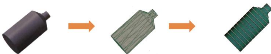
Figure 1-7 : Chaîne numérique précédant l'impression d'un objet 3D, à gauche le fichier CAO, au milieu le fichier STL et à droite le tranchage de la pièce.
