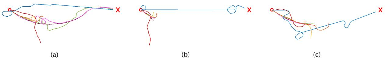
FIGURE 3.57 – Tracés de 3 chemins dans l’environnement *open-rect*. Le robot est en présence de 50 obstacles dont les vitesses suivent la loi *var-faible*.
