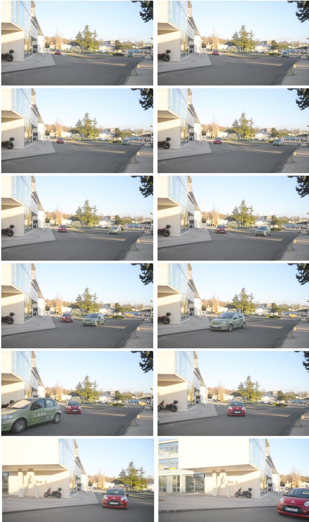
FIGURE 2.45 – Décision de céder le passage avec un seuil de TG agressif. La C1 rouge (ego) cède le passage à la C3 verte, en ne laissant qu'un faible délai entre les deux véhicules. Le TG mesuré entre les trajectoires est de  $-1,15$  s. L'écart entre 2 images successives est de  $0,5$  s.
