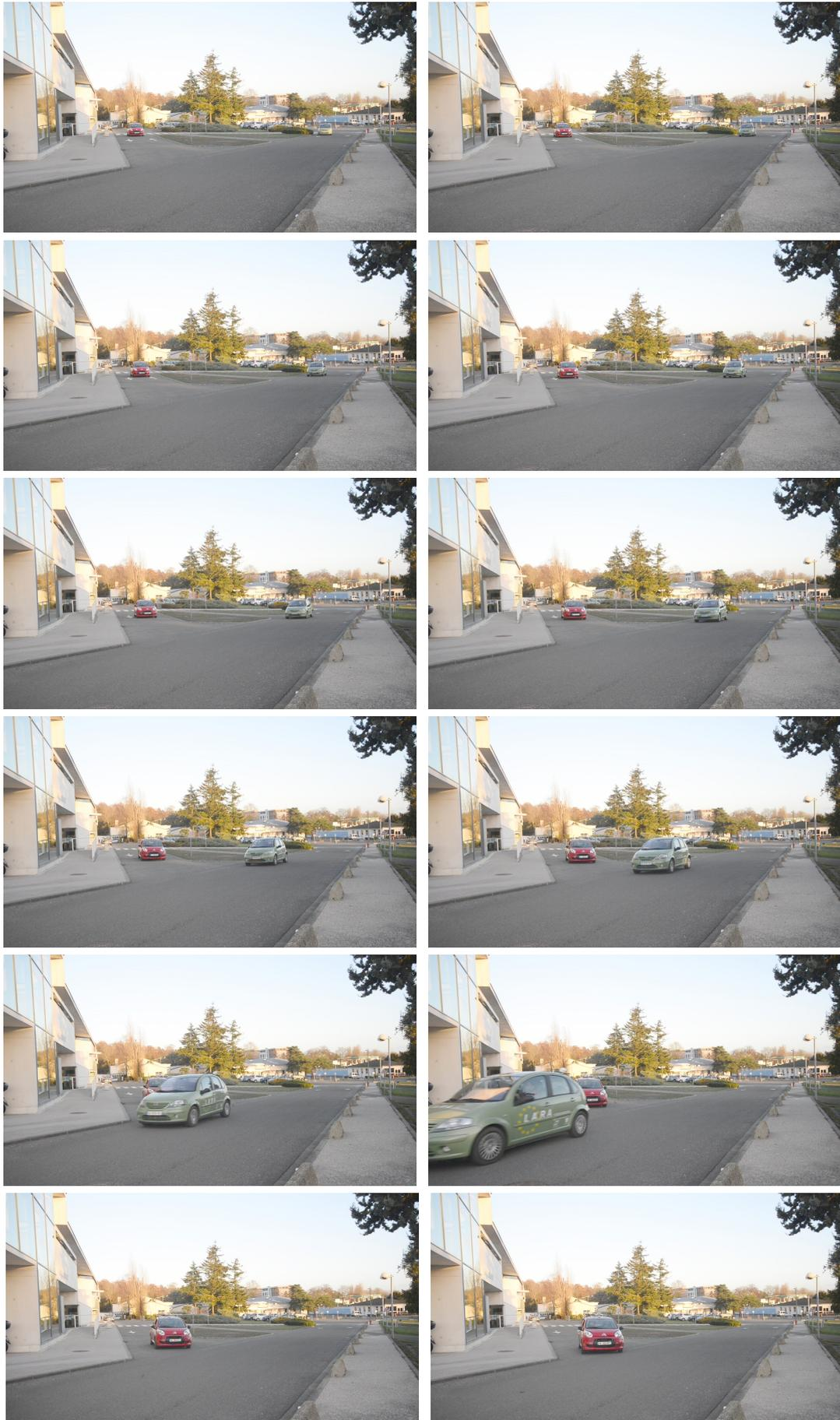
FIGURE 2.43 – Décision de céder le passage en situation réelle. La C1 rouge (ego) ralentit à 3,4 m/s pour céder le passage à la C3 verte qui circule à 8,6 m/s. Le TG mesuré entre les deux trajectoires est de  $-2,25$  s. L'écart entre 2 images successives sur la séquence est de 0,5 s.
