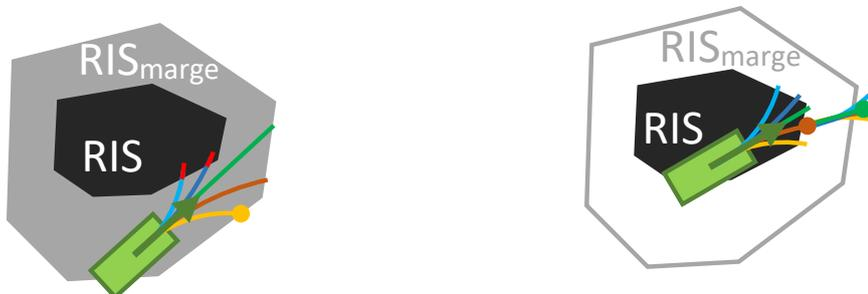
(a) Itération sur 5 tentacules lorsque le robot est dans un RIS calculé avec marge
