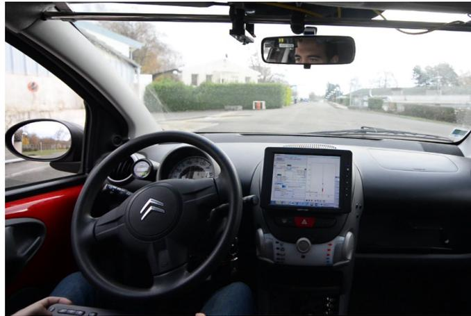
FIGURE 2.38 – Intérieur du véhicule automatisé : un écran permet de suivre le déroulement de la planification en temps réel.
