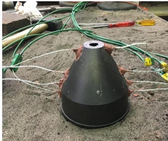
FIGURE 6.8 – Mise en place des thermocouples
