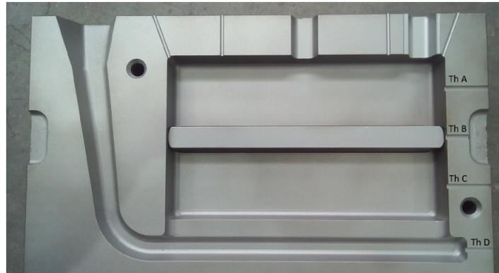
FIGURE 4.6 – Localisation des thermocouples dans le moule.
