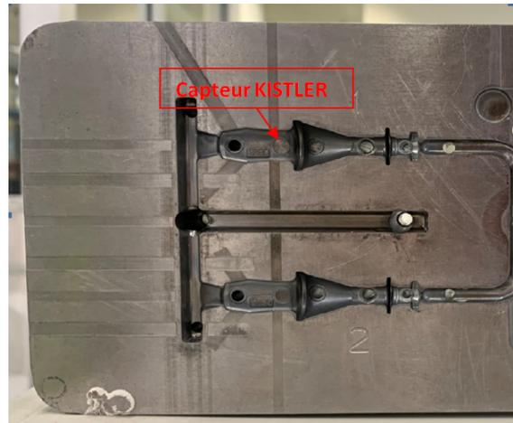
FIGURE 3.8 – Positionnement du capteur de pression
