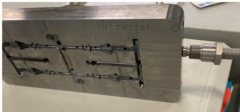
FIGURE 3.9 – Positionnement du thermocouple type J
