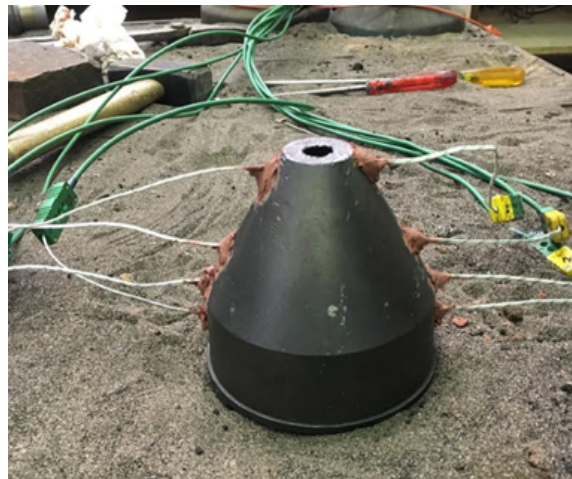
FIGURE 6.8 – Mise en place des thermocouples
