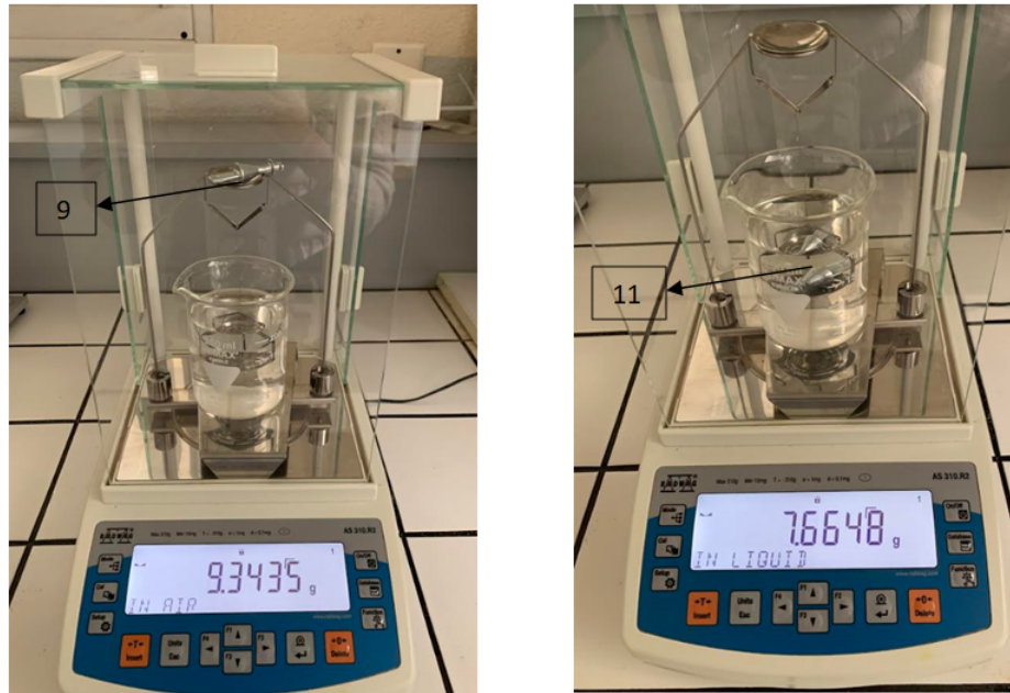
FIGURE 3.17 – (a) Pesée dans l’air (à gauche) ; (b) Pesée dans l’eau (à droite)
