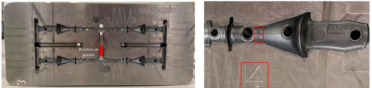
FIGURE 3.7 – (a) Demi moule mobile, (b) Zoom d’une empreinte
