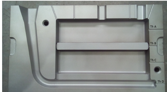
FIGURE 4.6 – Localisation des thermocouples dans le moule.
