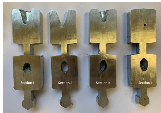
FIGURE 4.8 – Photos de certaines sections montrant la formation de macro-retassures
