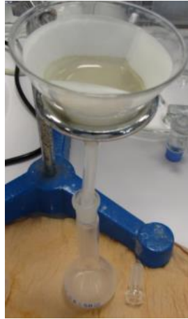
Figure 114 : Dispositif de filtration pour les particules supérieures à 100 \mu\text{m} .
