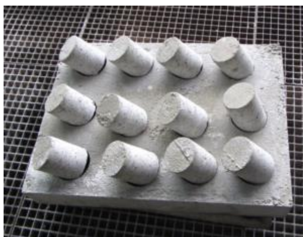
Figure 108 : Carottage des dalles.
