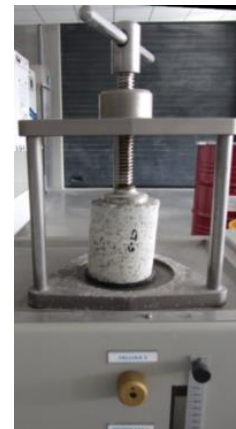
Figure 112 : Appareillage pour la mesure de la perméabilité à l'eau NF EN 12390-8[99]
