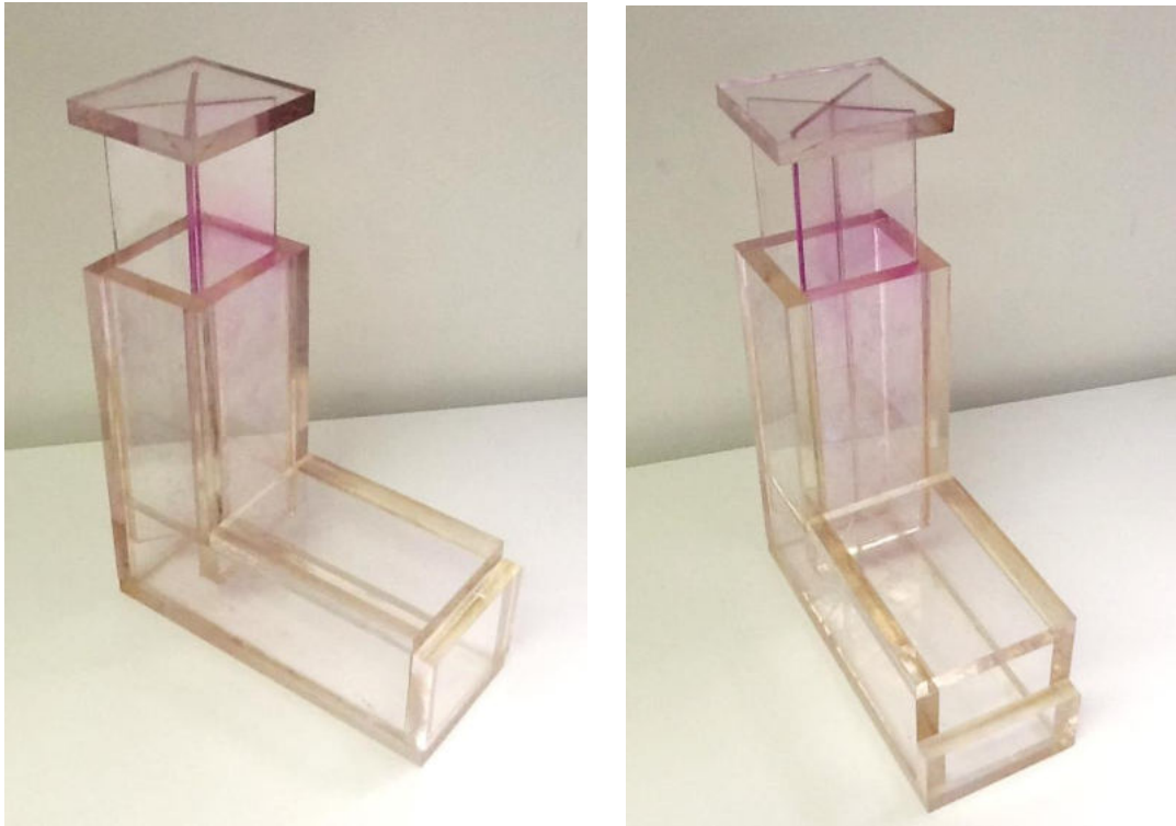
Figures 168 : Maquette d'essai en soufflerie, échelle 1/50
