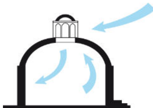
Figure I 16 : Fonctionnement d'un Kolah Farangui
