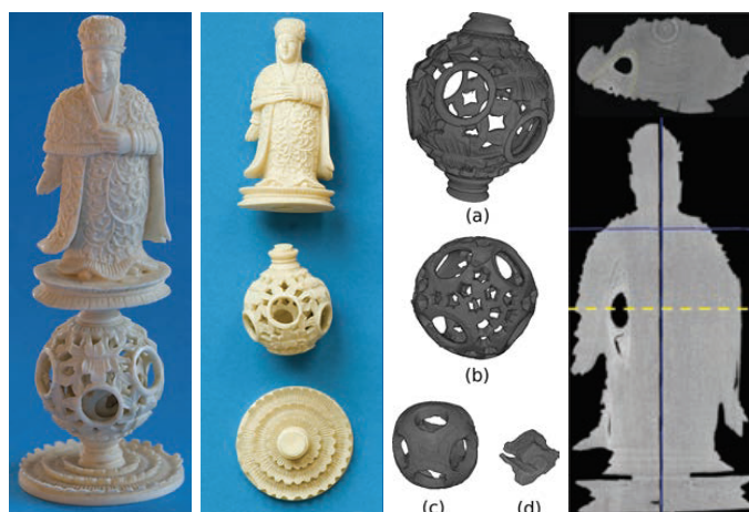
FIGURE 1.32 – De gauche à droite : La pièce originale, les trois parties imprimées en 3D, les différentes sphères imbriquées détectées à la tomographie, puis la structure interne de la figurine [LAYCOCK et al., 2013]
