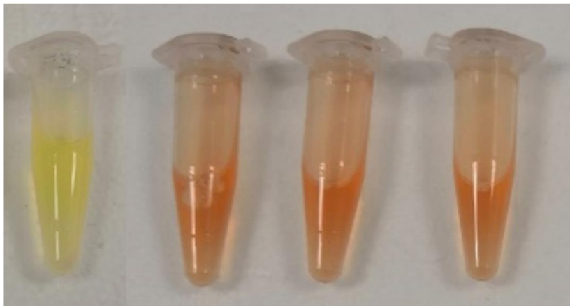
Figure 51. Test d'activité d'hydrolyse de la nitrocéfine à partir de bactéries entières. Un culot de 10 ml culture à DO_{600} = 2 de M. abscessus \Delta bla_{Mab} , M. abscessus CIP102436S et M. abscessus \Delta bla_{Mab}::bla_{Mab} -egfp R et M. abscessus \Delta bla_{Mab}::bla_{Mab} -egfp F a été resuspendu dans 1 ml de tampon PIPES 2 mM pH 6,8 contenant 50 \mu M de nitrocéfine. Après 3 heures d'incubation, les tubes sont pris en photo.
