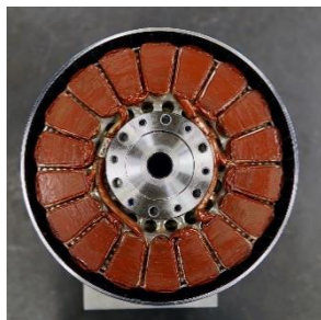
Figure 2-8 : Machine axiale EMRAX 268, 100kW @ 2000 tr/mn (vitesse max 5000 tr/mn), atteignant une puissance massique à régime d'environ 5 kW/kg (masse active) et un couple massique de 12 Nm/kg (a) [Emrax] (b) EMRAX 228 LV, 28kW @ 3000 tr/mn (basse tension) vue en détail.
