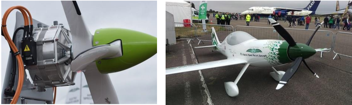
Figure 1-7 : Un moteur à pales contrarotatives à technologie axiale YASA 750R (750Nm@2750rpm) à haute densité de puissance, pesant seulement 37kg, motorise le P1e [Robinson], à gauche, et le P1e mock-up, à droite.
