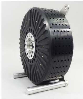
Figure 2-7 : Machine Siemens à motif Halbach 170 kW @ 6250 rpm (vitesse max 6500 rpm), atteignant une puissance massique à régime de 7kW/kg (masse active) et un couple massique de 11 Nm/kg [Siemens].
