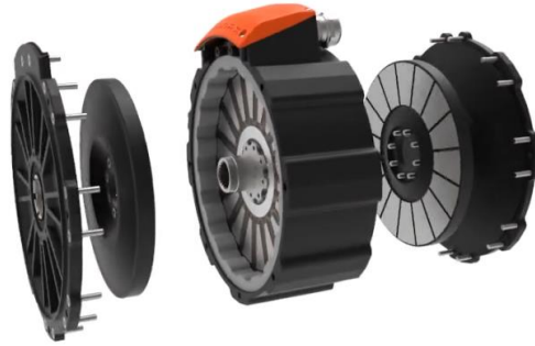
Figure 2-9 : Machine Magnax (AXF225) sans culasse statorique de 200 kW @ 7650 rpm (puissance max transitoire), atteignant une puissance massique pique de 12.5kW/kg (masse active) [Magnax].
