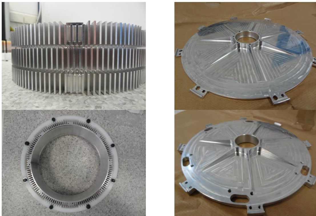
Figure 6-15 : Virole réalisée [Erneo] masse totale 2.3kg (0.6 kg flasque avant et 0.4 kg pour celui de derrier).
