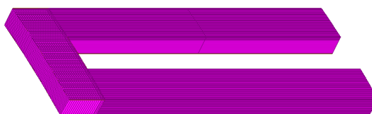
Figure 4-43 : Pré-découpage du domaine afin d'atteindre un maillage structuré dans Ansys Maxwell.
