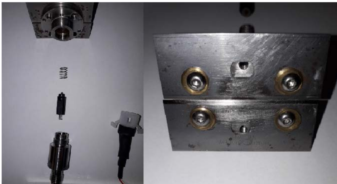
Figure2. 8 – A gauche : photographie des différents composants de la vanne pulsée. A droite : photographie de la fente réglable adaptée sur la face avant de la vanne pulsée.
