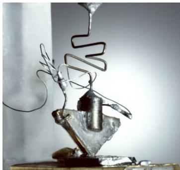
FIGURE 1 – Premier transistor en germanium à pointes de contact.
