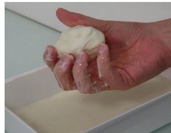
(b) En comprimant rapidement la main, la solution forme un solide.
