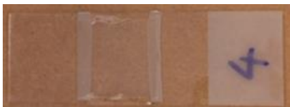
FIGURE 1.20 Fabrication d'une cellule d'observation pour le microscope optique.
