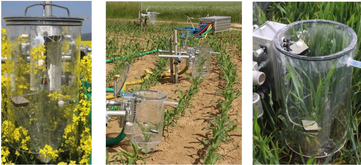
Figure 2-3 Vue des chambres installées au champ sur les plantes de colza, maïs et blé pendant la campagne de mesures
