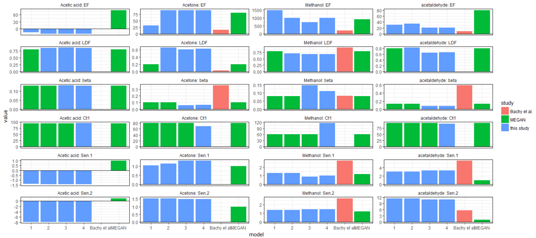
Figure 5-2: Valeurs des paramètres du modèle MEGAN 2.1 obtenues dans les 4 simulations considérées avec 1, 2, 3, ou 4 paramètres libres (this study), rapporté par Bachy (2018), et ceux indiqués par défaut dans le modèle MEGAN 2.1. Les facteurs d'émission EF sont donnés en \mu\text{g} \cdot \text{m}^{-2} \cdot \text{h}^{-1} and \beta in \text{K}^{-1} . Les deux dernières lignes indiquent la valeur de \gamma_A pour les périodes Sen1 et Sen2 . Dans MEGAN 2.1 et Bachy (2018) une unique valeur de \gamma_A est considérée pour toute la senescence. Bachy (2018) ne rapportent pas les valeurs des paramètres pour l'acide acétique, de C_{t1} , et de \gamma_A pour l'acétone.
