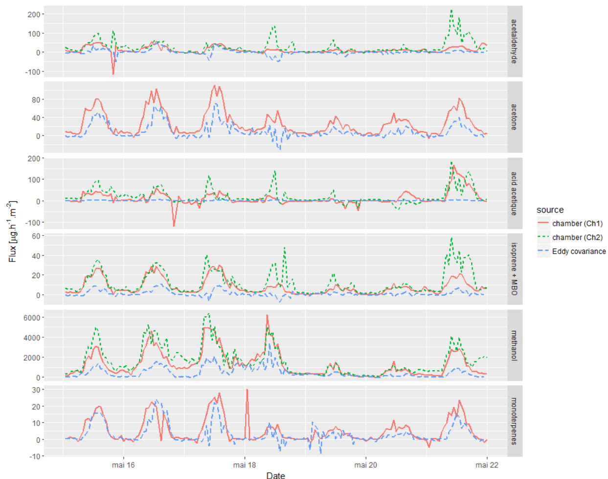
Figure 5-5 : Comparaison des flux mesurés par les chambres et par Eddy covariance pour 6 COVb sur le champ de colza. Les mesures de la chambre 2 pour l'acétone et les monoterpènes différaient fortement des mesures des autres systèmes et ont été exclues ici.
