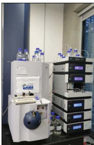
Figure 45 : Spectromètre de masse utilisé lors des expériences d'ESI-MS en conditions natives. L'ionisation des protéines a été réalisée par électroébulisaison (ESI classique). Les rapports m/z ont été calculés grâce à un analyseur à temps de vol (TOF) visible sur la gauche (la cheminée bleue). L'analyse peut être couplée à une HPLC (à droite) du moment que le tampon reste volatil. Photographie prise avec l'aimable accord d'Alexandra Berlioz-Barbier, responsable du centre Commun de Spectrométrie de Masse de l'Institut (ICBMS, UMR5246)
