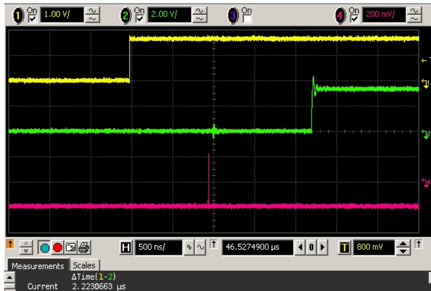
FIGURE 3.4 – Observation des signaux sur oscilloscope montrant le signal d'entrée en couleur jaune, le signal de sortie en vert récupéré depuis le Xilinx Virtex-II Pro et une impulsion EM en magenta générée durant le temps de propagation.
