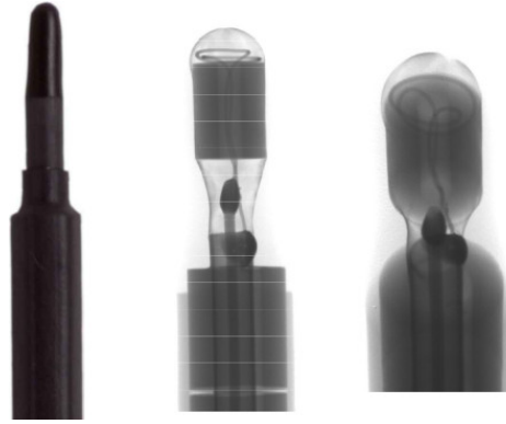
FIGURE 2.5 – Image au rayon X d'une sonde Langer RF2-B32 à noyau d'air.
