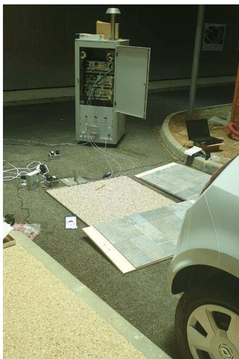
Figure VI-12. Photo de l'agencement, nommé Sols, des surfaces dépolluantes lors de la campagne de juillet 2019 dans Sense-City.
