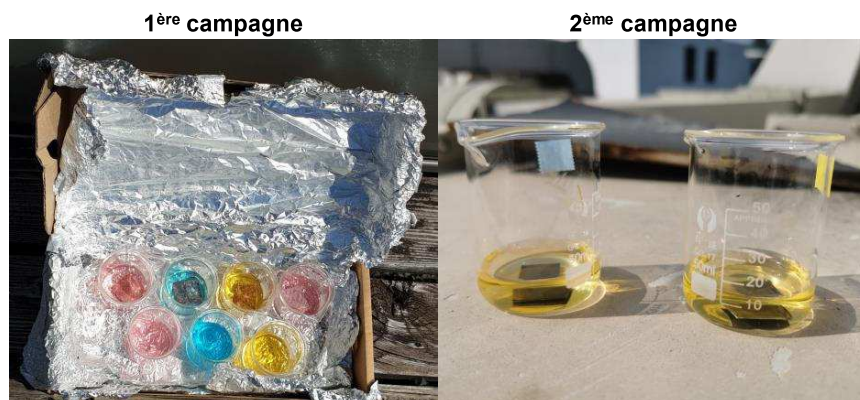
Figure II-20. Photos des montages expérimentaux de dépollution de l'eau sous lumière solaire naturelle.
