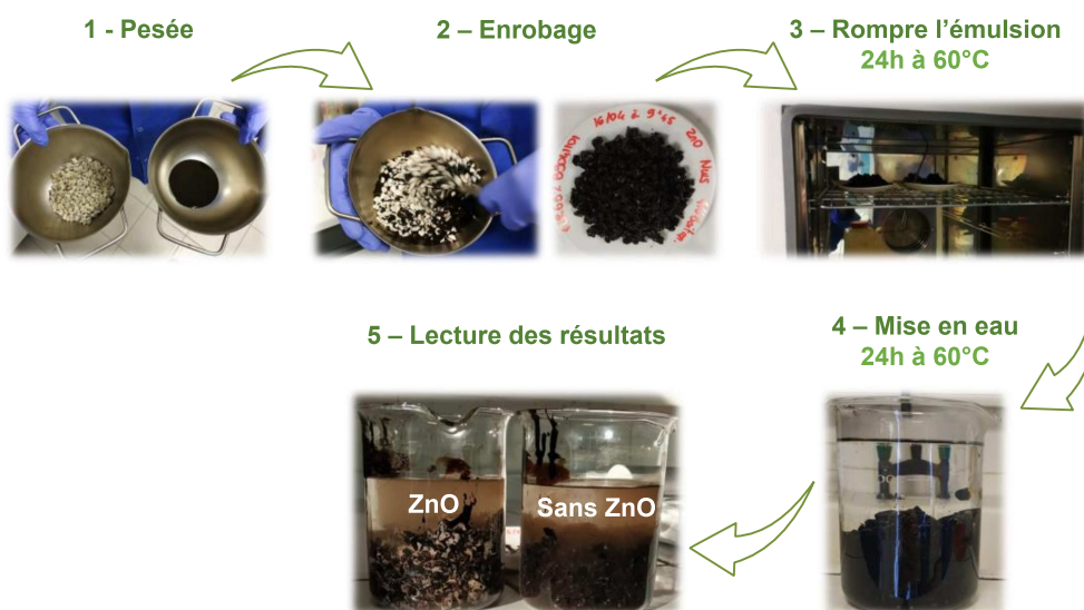
Figure VII-1. Photos du test d'adhésivité passive mené en 2019 à EIFFAGE.
