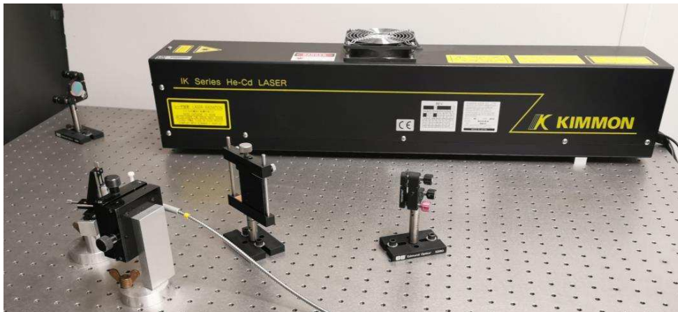
Figure II-12. Photo du montage expérimental du dispositif de mesure PL.
