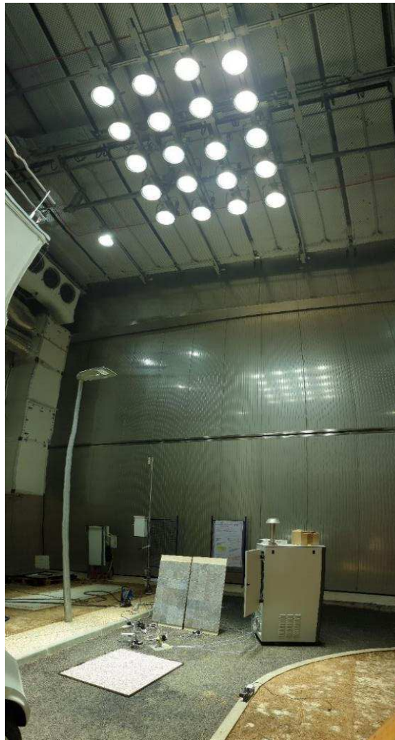
Figure VI-7. Photo de l'agencement, nommé Murets, des surfaces dépolluantes lors de la campagne de juillet 2019 dans Sense-City.
