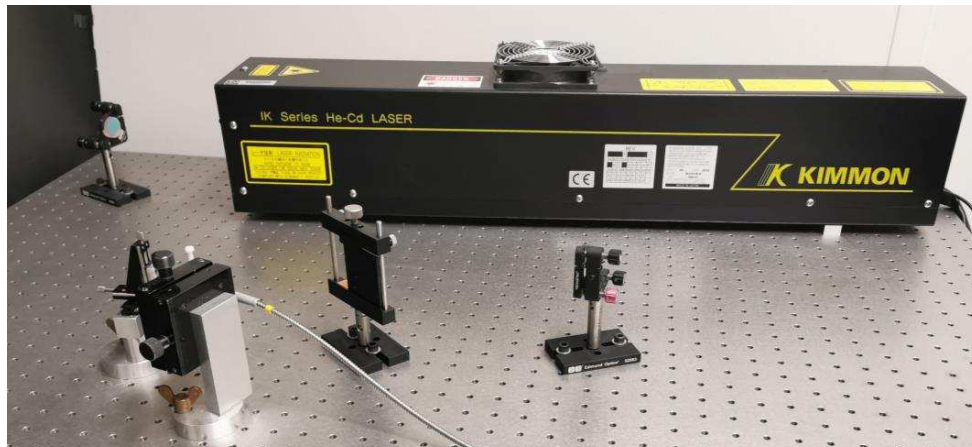
Figure II-12. Photo du montage expérimental du dispositif de mesure PL.
