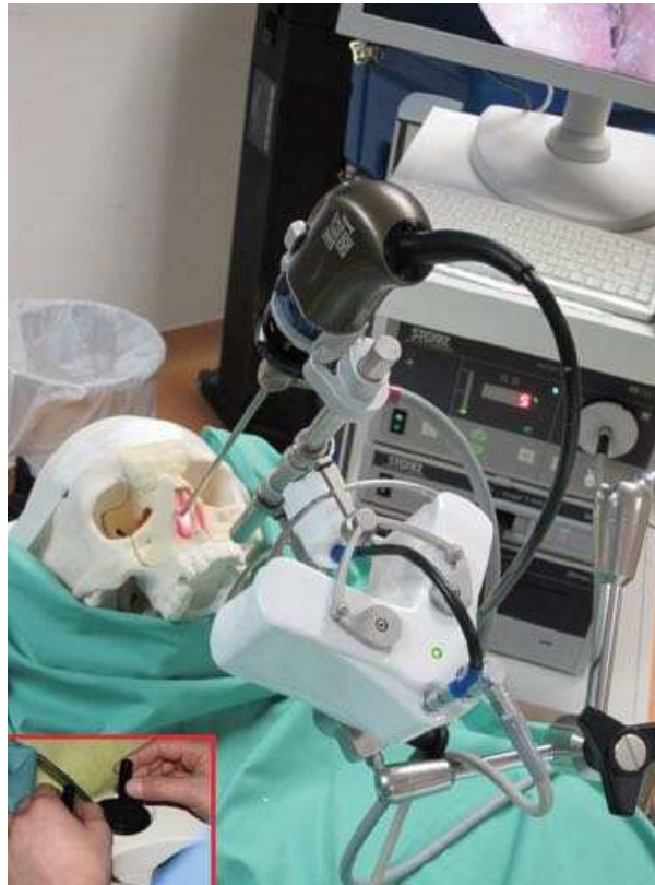
FIGURE 4.15 – Robot porte endoscope de Fisher et al [26], spécifiquement dédié à la chirurgie endonasale, avec commande par deux joysticks.
