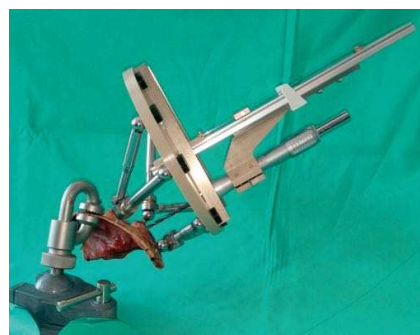
(b) Robot RoboJig directement attaché à l'os temporal, comme le Microtable.
