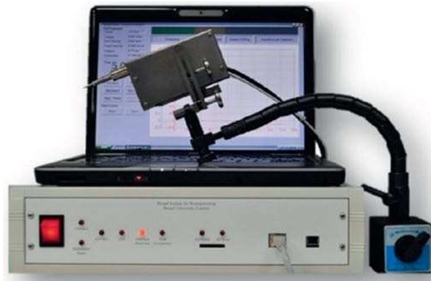
FIGURE 4.6 – Système “Smart Micro-Drill”, utilisé pour le fraisage de la cochlée avec arrêt automatique lorsqu’il n’y a plus d’os [19].
