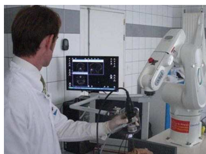
(b) Système HYBRID, utilisant le robot industriel en série Viper et le manipulateur Evolap, en laboratoire d'anatomie pour la chirurgie endonasale.
