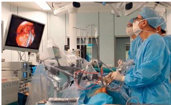
FIGURE 4.16 – Prototype Surgidelta utilisé en salle d'opération, avec système d'aspiration et de lavage intégré (flèche noire) [13].
