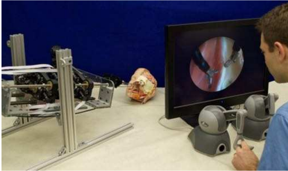
FIGURE 4.21 – Robot à deux canules actives pour la chirurgie de la base du crâne par voie endonasale, contrôlé par deux interfaces haptiques [10].
