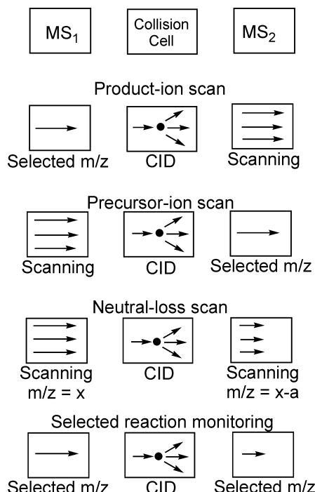
Figure 26. Mode de scan communément utilisés en MS/MS
