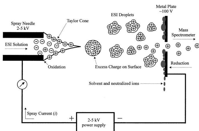
Figure 24. Mécanisme de formation des ions dans une source ESI (Cech and Enke, 2001)<sup>349</sup>
