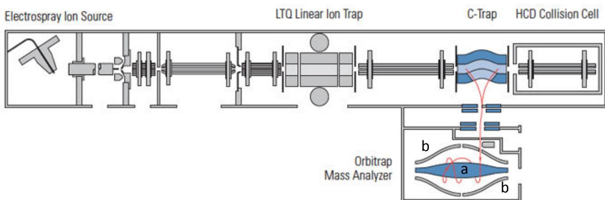
Figure 29. Représentation schématique de l'analyseur Orbitrap LTQ XL (ThermoFisher Scientific) avec (a) l'électrode centrale et (b) l'électrode extérieure<sup>356</sup>
