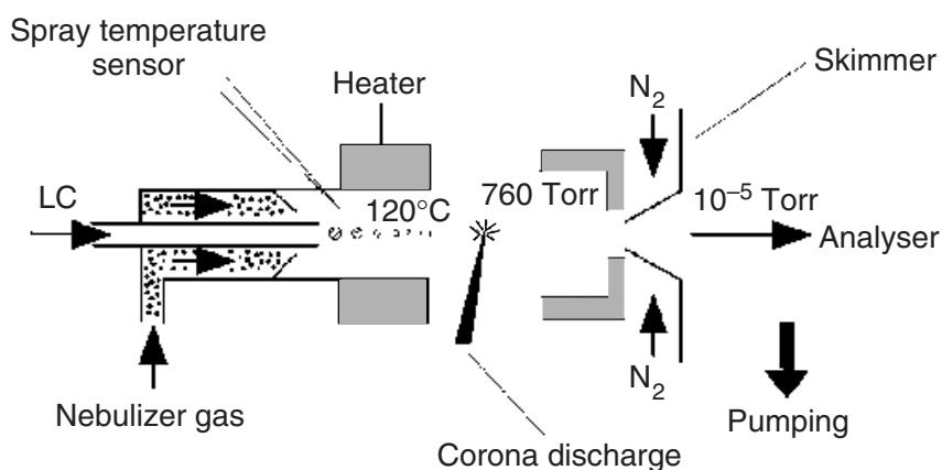
Figure 25. Fonctionnement d'une source APCI.<sup>351</sup>
