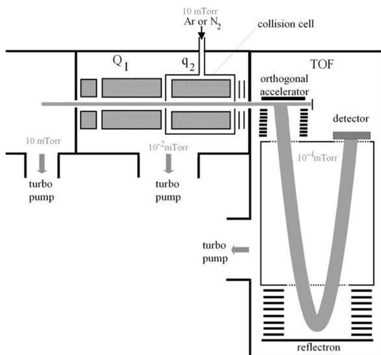
Figure 28. Fonctionnement schématique d'un analyseur Q-TOF. (D'après Hoffman and Stroobant 2007)<sup>351</sup>
