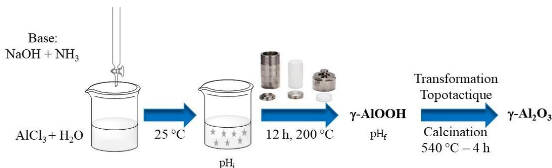
Figure 65: Protocole de synthèse par précipitation à partir de sels d'aluminium avec ajout d'un mélange de base<sup>9</sup>.
