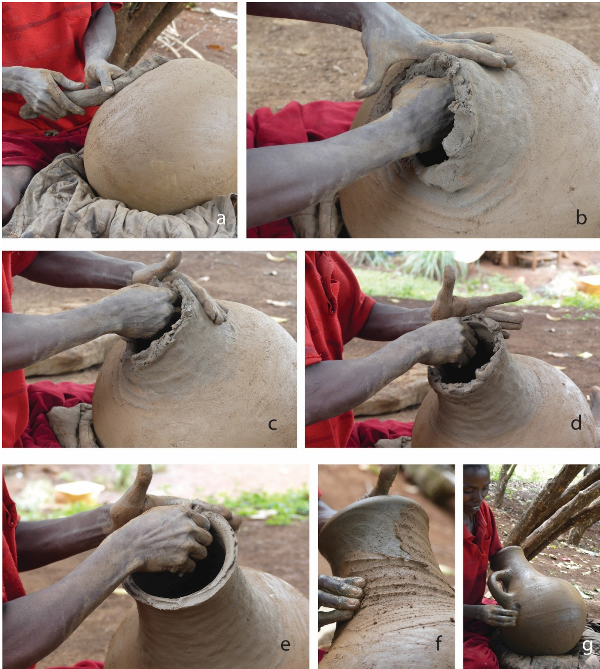
Fig. 3.10. Façonnage du col d'une jarre moyenne au sein de la tradition A' pratiquée par les potières Aari dans le village de Yetnebersh : a) Pose d'un gros colombin sur la face externe pour l'ébauchage du col ; b) Le colombin est aminci par des pressions discontinues effectuées à l'aide du plat de l'index, selon des mouvements horizontaux (amincissement par écrasement) ; c) des colombins de très faible épaisseur sont ajoutés, posés et amincis par écrasement afin de régulariser l'épaisseur de la paroi ; d) Pressions discontinues appliquées avec le plat de l'index, selon des mouvements horizontaux, servant simultanément à l'ébauchage et à la mise en forme du col ; e) Préformage et lissage de la lèvre par des pressions discontinues en pincement réalisées à l'aide du pouce et des index ; f) Enduction de l'argile rouge au niveau du col ; g) Lissage final du récipient à l'aide de l'outil en gousse.
