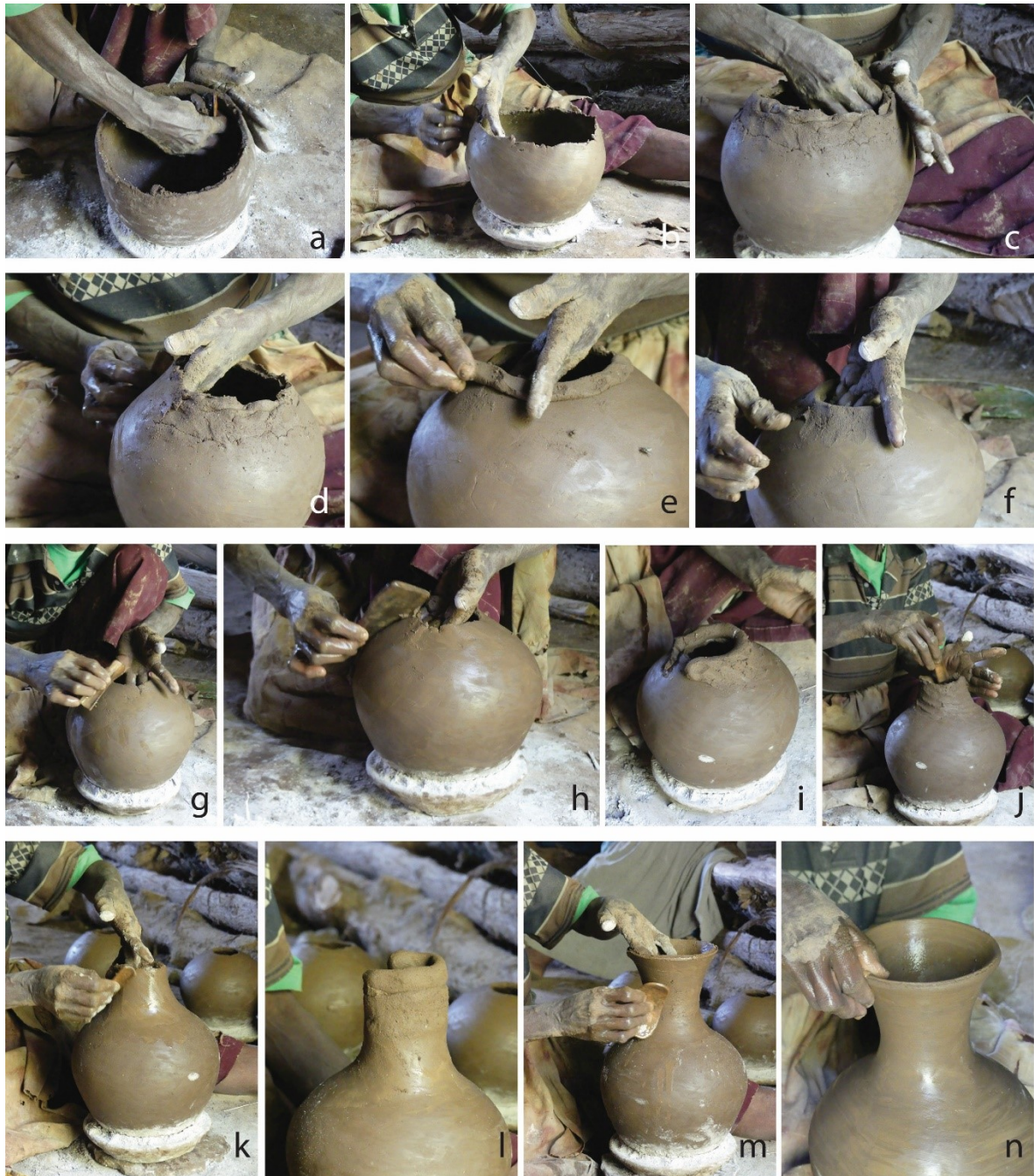
Fig. 3.55. Façonnage de la partie supérieure d'une jarre de taille moyenne au sein de la tradition F, par Fesses, potière Amhara du monastère de Menteq : a), b) Raclage de la face interne du corps inférieur à l'aide d'une estèque en calebasse, puis de la face externe ; c) Amincissement par étirement de segments de colombin posés sur la face interne pour l'ébauchage du corps supérieur ; d) Mise en forme du corps supérieur par raclage à l'aide de l'estèque en bambou ; e) Pose d'un colombin sur la face externe pour l'ébauchage de l'épaule du récipient ; f) Jointure par étalement de l'argile à l'aide du pouce ; g) Amincissement du colombin par étirement à l'aide de l'outil en bambou, sur la face externe ; h) Mise en forme de l'épaule du récipient par raclage de la face externe à l'aide de l'estèque en bois ; i) Pose d'un colombin sur la face externe pour l'ébauchage du col ; j) Mise en forme du col par raclage sur la face interne à l'aide d'une estèque en bambou ; k) Mise en forme de la base du col par raclage sur face externe à l'aide d'une estèque en bambou ; l) Pose d'un colombin sur la face interne pour ébauchage de la lèvre ; m) Mise en forme du col par raclage sur face externe à l'aide d'une estèque en calebasse ; n) Mise en forme et lissage de la lèvre par des pressions continues en pincement réalisées à l'aide d'une pièce de cuir.
