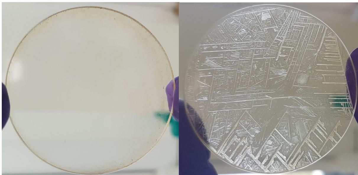
Figure IV-2 : Photo d'un film a) préparé à partir de 2 mL de 0,5 M furfural b) préparé à partir de 2 mL de 0,5 M furfural/0.1 M  $KNO_3$
