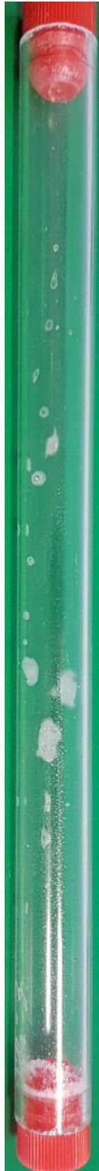
Figure B-1 : Photo d'un film non homogène d'acide stéarique (1 mL 0.1 M) + nitrate de potassium (3 \* 250  $\mu$ L 0,027 M) séché au pistolet à chaleur
